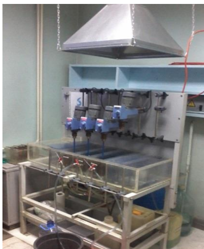
Рисунок 29 - Установка с 2 камерами экстракции и 1 камерой реэкстракции
