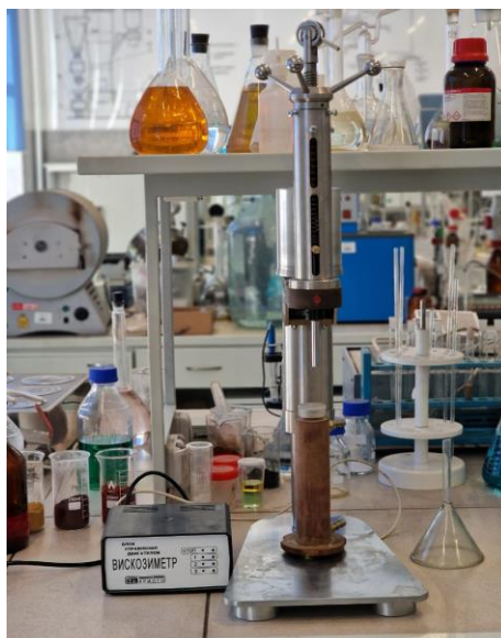
Рисунок 27 - Определение вязкости органики вискозиметром АКВ-2ЖВ
