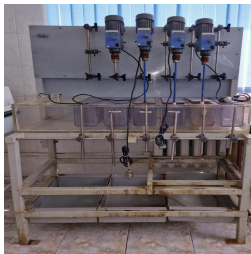
Рисунок 29 - Установка с 2 камерами экстракции и 1 камерой реэкстракции
