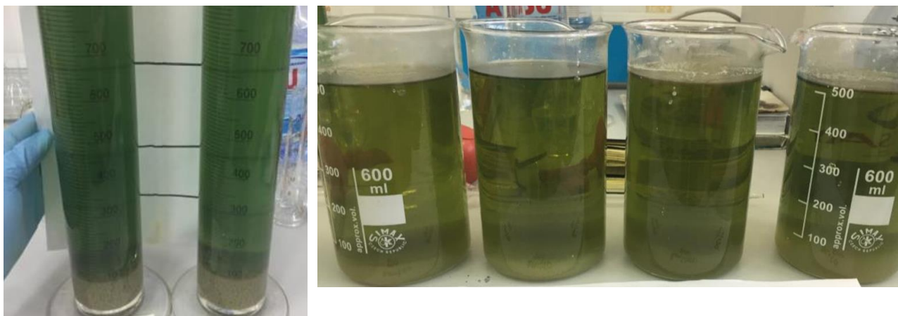
Рисунок 48 – Распределение фаз после центрифугирования: органическая фаза (экстрагент); уплотнённая твердая фаза; водный медесодержащий раствор
